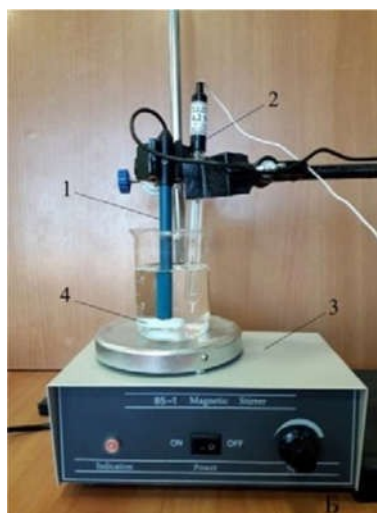
Рис. 2. Установка для определения концентрации (активности) хлорид-ионов в растворе. А: 1 — корпус датчика для определения \text{Cl}^- -ионов; 2 — разъём Micro USB для подключения к компьютеру; 3 — разъём BNC для подключения рабочего электрода; 4 — разъём для подключения электрода сравнения. Б: 1 — ионоселективный электрод (рабочий электрод); 2 — электрод сравнения (хлорсеребряный электрод); 3 — магнитная мешалка; 4 — якорь магнитной мешалки
